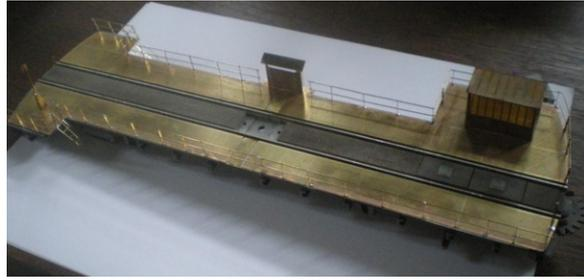
1-découper les pieds de rambarde et vérifier le passage des fils de laiton ,avant de souder les pieds.
